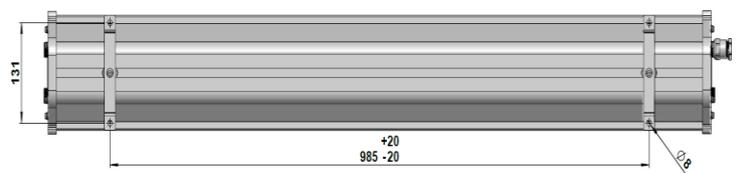
Fixe os perfis de suporte da luminária na parede, teto ou estrutura metálica, utilizando parafusos e arruelas lisa e de pressão conforme diâmetro do furo.
